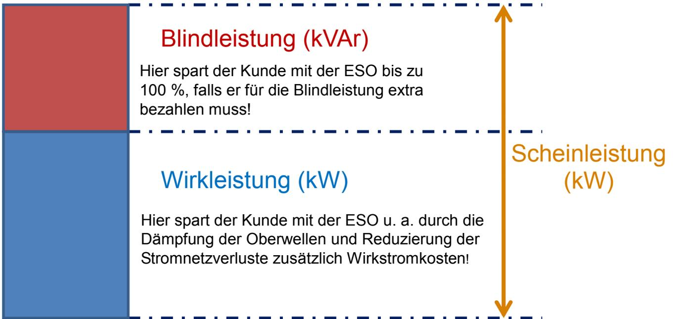
Die aus dem elektrischen Netz entnommene **Leistung P** ist gleich dem Produkt aus der **Spannung U**, dem **Strom I** und dem **Phasenverschiebungswinkel  $\varphi$  (Phi)**.
