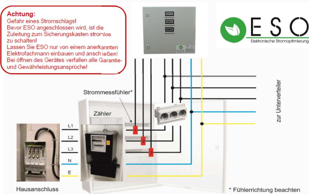
Der Anschluss erfolgt punktuell, nicht seriell. So sind die Kondensatoren zwischen dem Leiter L und dem Neutraleiter N parallel zum angeschlossenen induktiven Verbraucher geschaltet, und dies für alle drei Phasen L1, L2 und L3.
